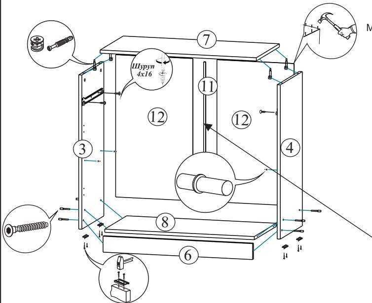
Отверстия под ручки досверлить сверлом D5.
