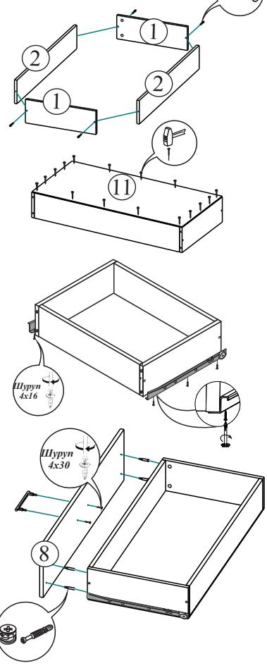
Отверстия под ручки досверлить сверлом D5.
